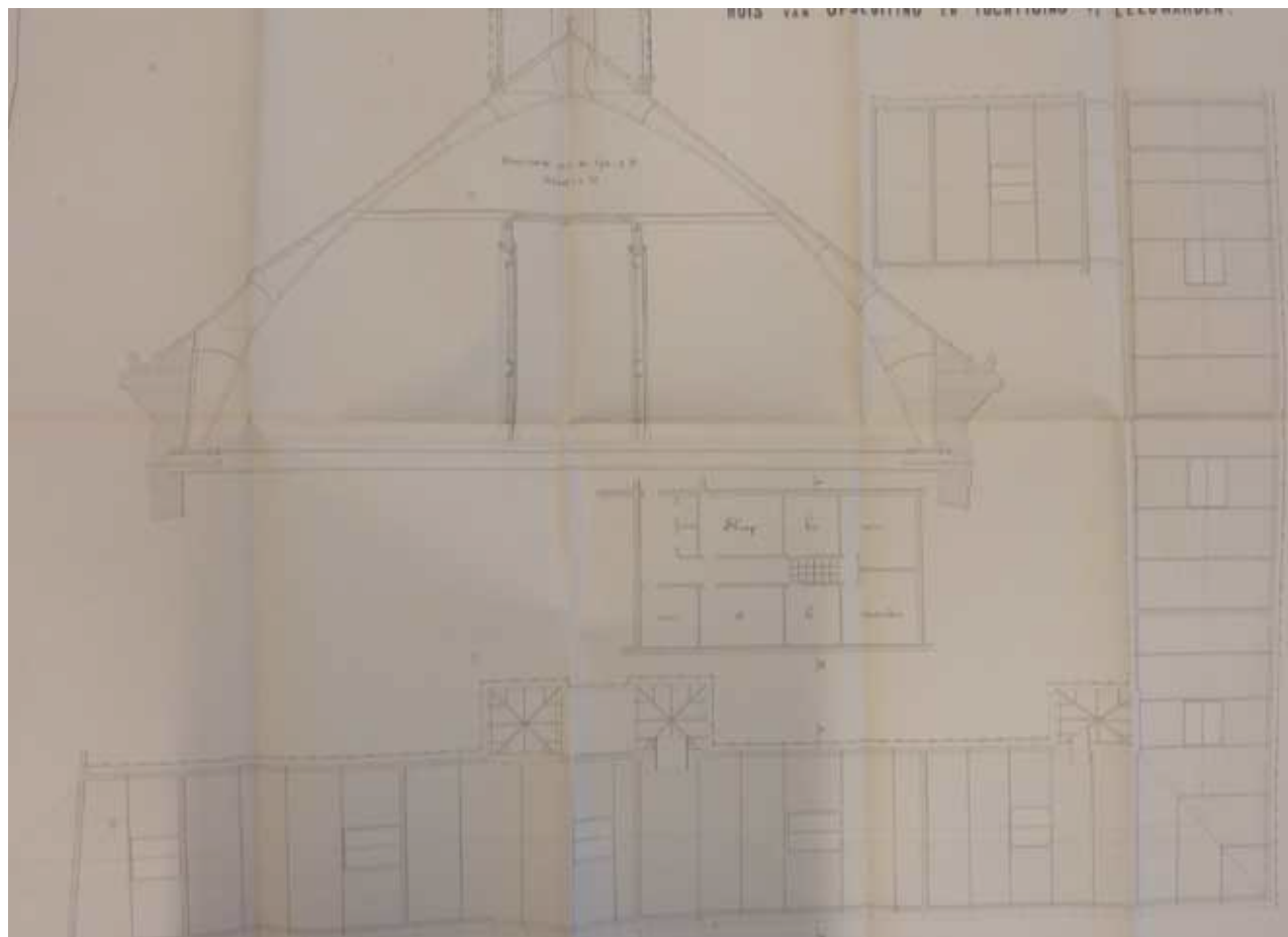
Afbeelding 137. Fragment van de bouwtekening van bouwdeel D, door J.F. Metzelaar, 1872. De afbeelding geeft de doorsnede van de kapconstructie en daklicht in de nok weer. Deze tekening behoorde bij de werkzaamheden voor het tweede perceel van de verbouwing van het 'Huis van Opsluiting en Tuchtiging te Leeuwarden' . Collectie Tresoar, archieven gevangeniswezen, toegangsnr: 50-01, inv.nr: 717.
